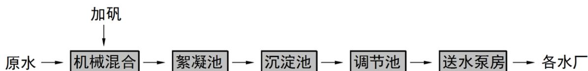
图 5-22 预处理工艺流程图
