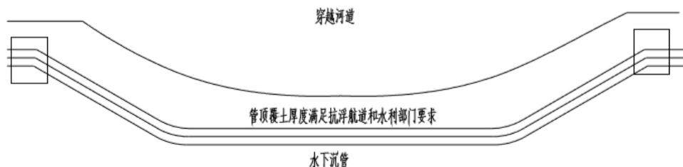
图 5-17 沉管施工弹性敷设法示意图
